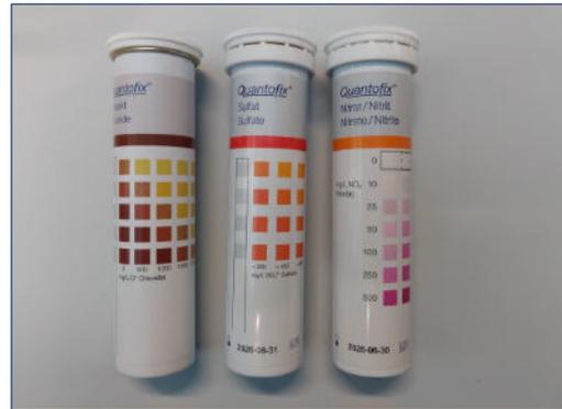
Abb. 135 Schnelltests Chloride, Sulfate, Nitrate, Nitrite
